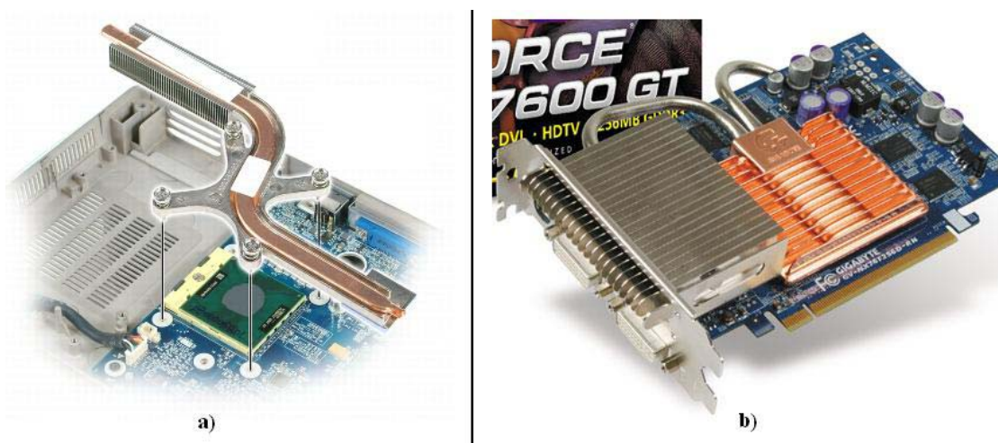
Figura 1 - Aplicação de heat pipes em computadores.
